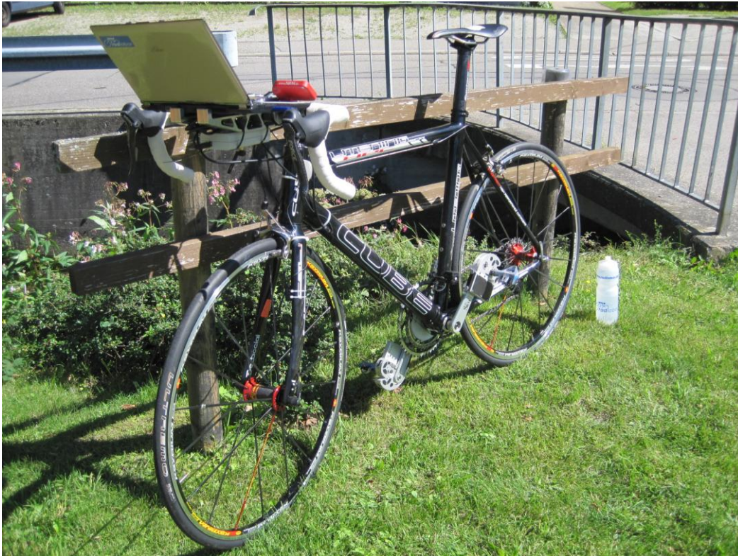
Abb.2: Das Messrad mit Netbook und Powerforce Messsystem.
