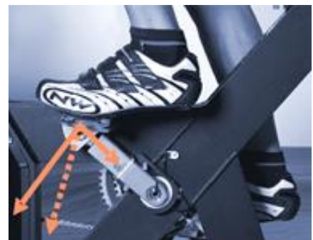
Powertec-System zur Pedalkraftmessung am SRM-Ergometer
